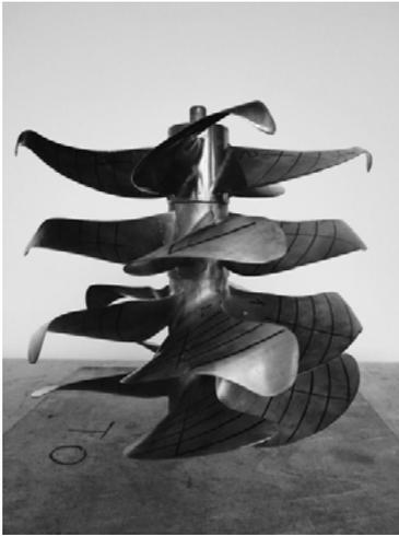
Abb. 5: In der HSVA untersuchte Modellpropeller zum HSVA Hamburg Container Ship (HCS)
