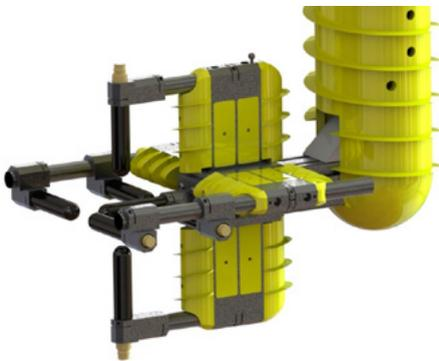
Links: 3D Hydroschallintensitätssonde mit 7 Hydrofonen für Beamforming Analysen
