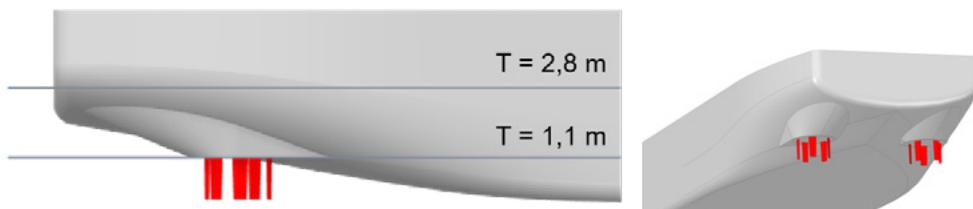
Abb. 9: Maßgeschneiderter Hinterschiffsentwurf für den Rhein mit zwei Zykloidalpropellern, ausgelegt für einen Mindesttiefgang von  $T = 1,1 \text{ m}$ , Quelle: Voith/DST
