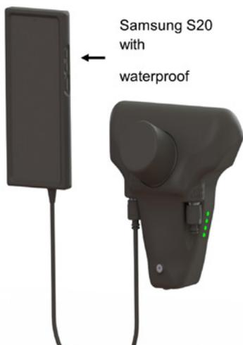
Abb. 11: Tauchermodem mit Anzeige- und Bedienkonsole
