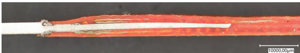
Abb. 3 Querschnitt eines monolithischen FVKs mit integriertem FAUSST-Verbinder.
