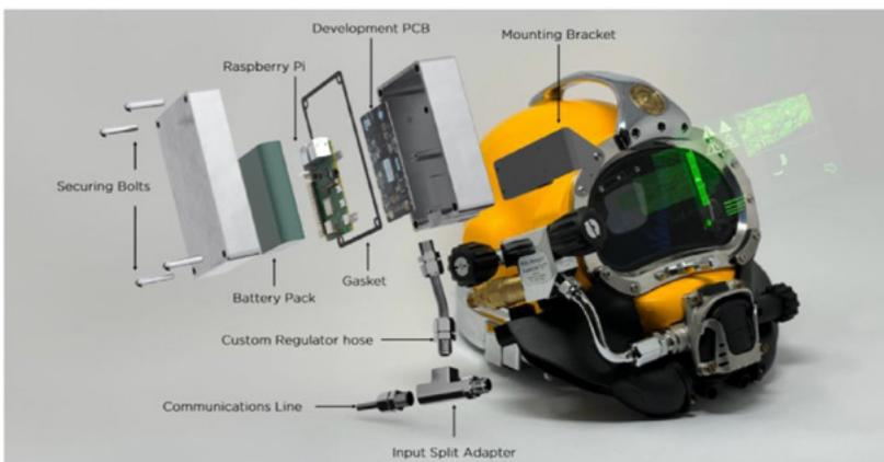
Abb. 13: Entwickeltes, prototypisches AR Gesamtsystem mit Taucherhelm
