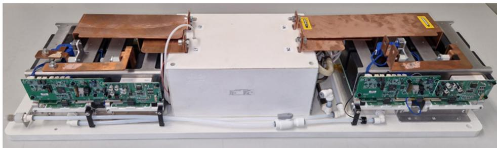
Abb. 4: Dual-Active-Bridge Wandlermodul
