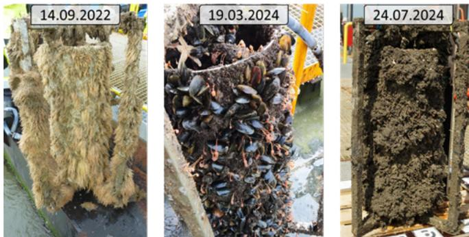
Abb. 7: Gegenüberstellung dreier unterschiedlicher Zeitpunkte während der Sukzessionsphase von marinem Bewuchs an zylindrischen Probekörpern.
