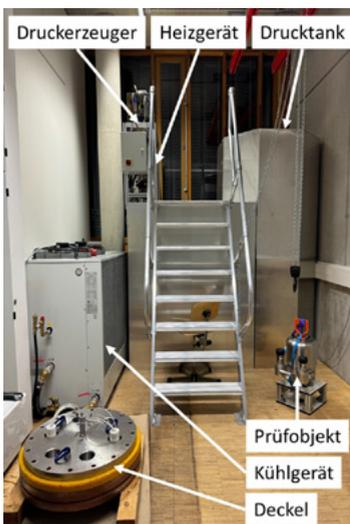
Abb. 8: Umweltsimulator bestehend aus Drucktank mit Heiz-/Kühlfunktion
