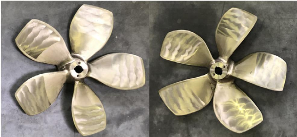
Abb. 2: Fünfflügler mit variiertem Skew, Multipulsion-Konzept
